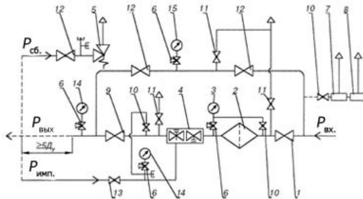
1-запорная арматура; 2-фильтр; 3-входной манометр; 4-регулятор давления газа; 5-предохранительный сбросной клапан; 6-кран трехходовой; 7-регулятор давления газа (на отопление); 8-газогорелочное устройство; 9-запорная арматура; 10-13-запорная арматура; 14-выходной манометр; 15-манометр.
