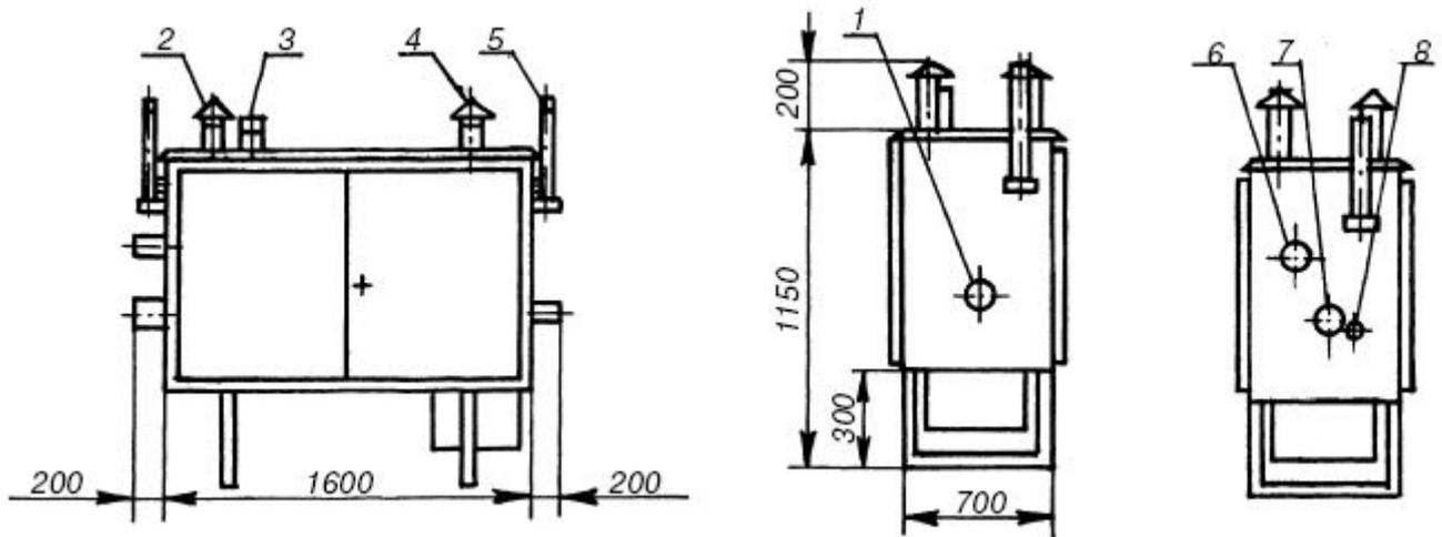
1-Р<sub>вх.</sub>; 2-дымоход; 3-выход клапана предохранительного сбросного; 4-вентиляционный патрубок; 5-продувочный патрубок; 6- вход клапана предохранительного сбросного; 7-Р<sub>вых.</sub>; 8-подвод импульса к регулятору.
