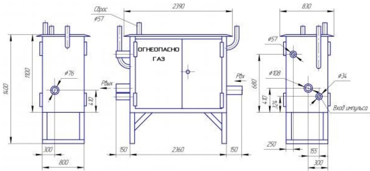
1-Рвих; 2-дымоход; 3-выход клапана предохранительного сбросного ПСК; 4-вентиляционный патрубок; 5-продувочный патрубок; 6-выход клапана предохранительного сбросного ПСК; 7-Рвых; 8-подвод импульса к регулятору.
