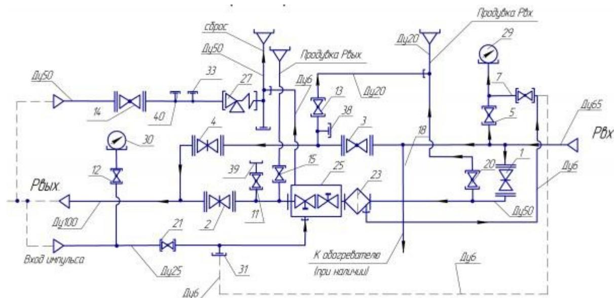
1,2 – задвижка Ду80, Ру16; 3,14 – кран шаровой Ду50; 4 – задвижка Ду50; 5,7,11,12 – кран шаровой Ду15; 13,15,20 – кран шаровой Ду20; 21 – кран шаровой Ду25; 23 – фильтр ФГВ-80/15, 25 – регулятор типа РДГ-80; 27 – клапан предохранительный сбросной ПСК; 29 – манометр входного давления; 30 – манометр выходного давления; 31,33 – штуцер для подключения выходного давления (M14x1); 38 – штуцер для подключения манометра входного давления; 39,40 – штуцер для подключения манометра выходного давления.
