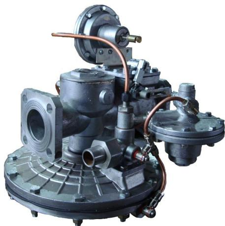
Регуляторы давления газа типа РДГ [РДГ-50, РДГ-50Н, РДГ-50В] предназначены для установки в газорегуляторных пунктах ГРП систем газоснабжения городских и сельских населённых пунктов, в ГРП и газорегуляторных установках ГРУ промышленных и коммунально-бытовых предприятий. Регуляторы обеспечивают снижение входного давления газа и автоматическое поддержание заданного давления на выходе независимо от изменения расхода газа и входного давления.
