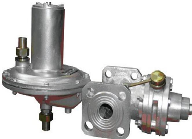
Регуляторы давления газа универсальные РДУ-32 предназначены для редуцирования высокого и среднего давления на низкое, автоматического поддержания выходного давления на заданном уровне независимо от изменений расхода и входного давления, автоматического отключения подачи газа при аварийных повышении и понижении выходного давления и понижении входного давления по сравнению с допустимыми заданными значениями.
