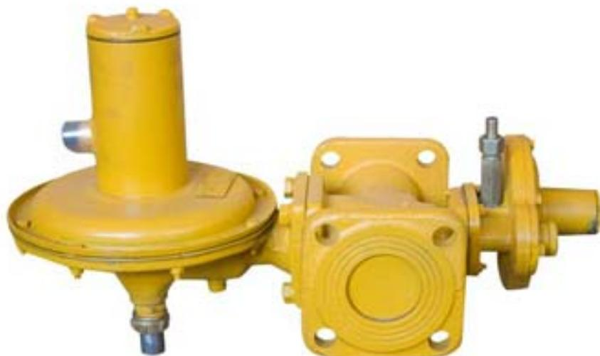
Регуляторы давления газа предназначены для очистки газа от механических примесей, снижения высокого или среднего давления газа на низкое, автоматического поддержания низкого выходного давления на заданном уровне независимо от изменений расхода и входного давления сброса газа в атмосферу и автоматического отключения подачи газа при изменении выходного давления сверх допустимых заданных значений.
