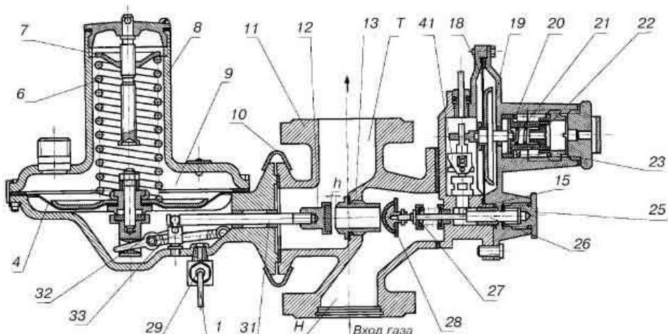
Регулятор давления газа РДНК: 1 — импульсная трубка; 6, 20, 21, 27, 33 — пружины; 4, 18 — мембрана; 7 — нажимная гайка; 8 — стакан; 9 — мембранный камера; 10 — хомут; 11 — корпус; 12 — рабочий клапан; 13 — седло; Т — выходной патрубок; 15 — фиксатор; 19 — отключающее устройство; 22, 23 — регулировочные гайки; 25 — пробка; 26, 31 — штоки; 28 — отсечной клапан; 29 — тройник; 32 — рычажной механизм; 41 — исполнительный механизм; Н — входной патрубок
