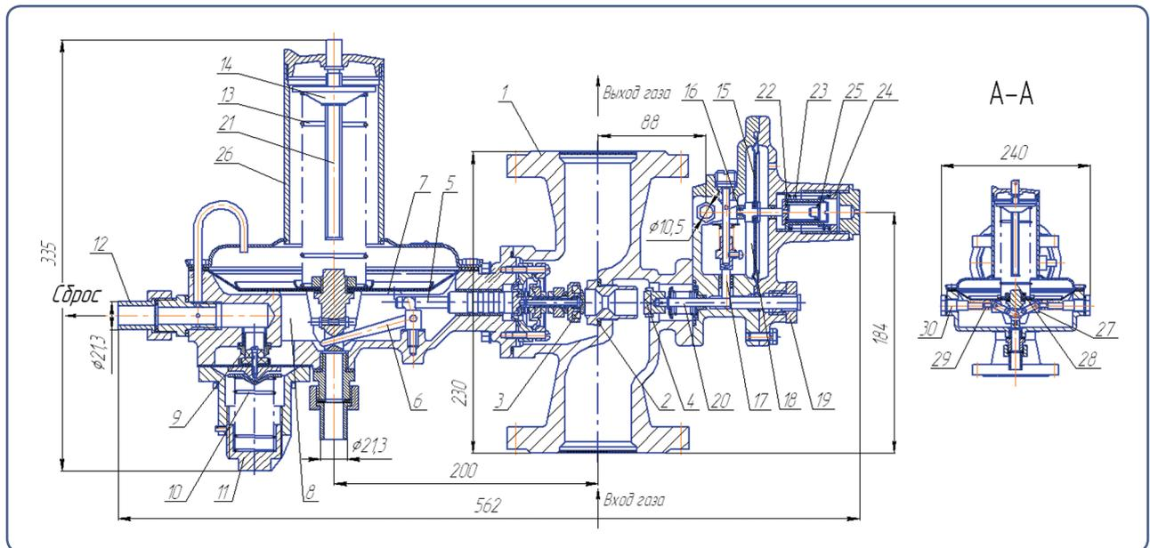
1 – крестовина; 2 – седло; 3 – рабочий клапан; 4 – отсечной клапан; 5 – шток; 6 – рычажный механизм; 7 – рабочая мембрана; 8, 18 – подмембранная полость; 9 – сбросной клапан; 10, 22, 23, 29 – пружина; 11 – стакан регулировочный; 12 – патрубок; 13 – пружина; 14 – гайка; 15 – мембрана; 16, 28 – толкатель; 17 – шток; 19 – пробка; 20 – шток; 21 – винт регулировочный; 24 – втулка; 25 – пробка; 26 – стакан; 27 – ползун; 30 – направляющая.
